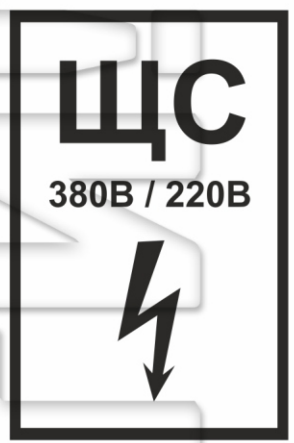
Т 52-02 Знак щита силового
